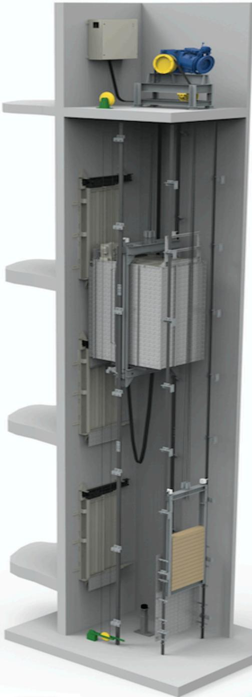
El elevador de tracción mecánica, la ubicación del cuarto de máquinas se ubica en la azotea. en la parte superior del cubo.
